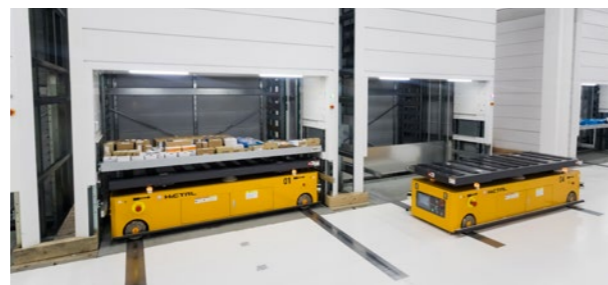
2019年8月10日，江苏一联合智造有限公司正在工作中的基于5G网络的自动导引运输车
